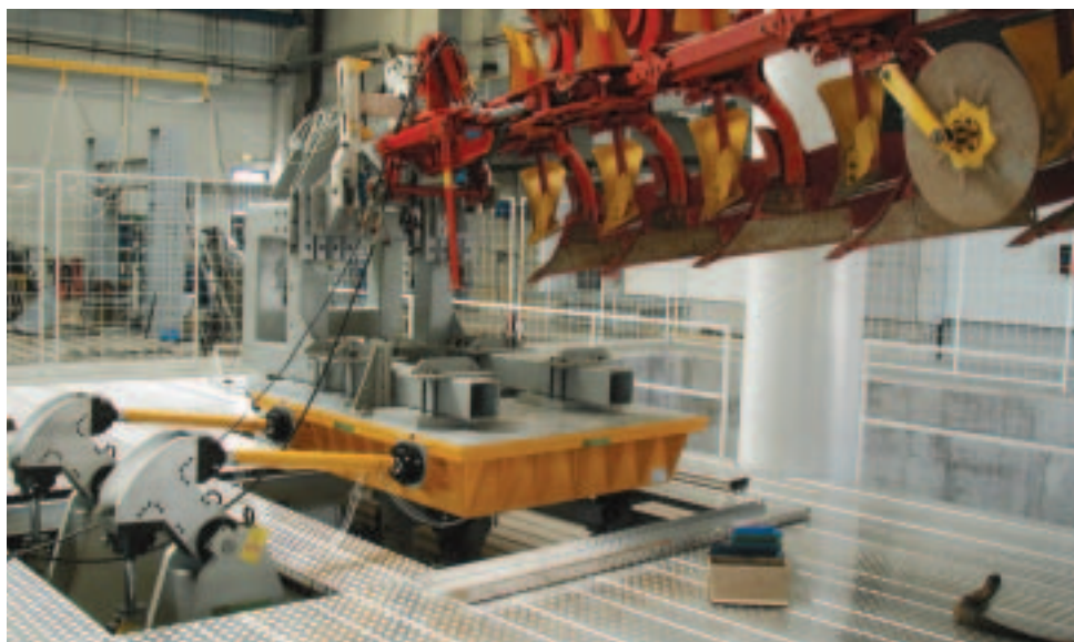
Als größte Prüfinstallation beeindruckte der MAST (Mehraxialer Schwingtisch) die Teilnehmer.
