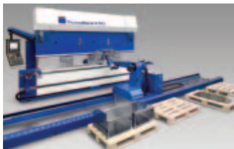
Die Abkantpressen der TrumaBend-Serie stehen für flexibles und produktives Abkanten.
