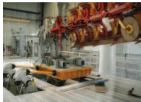
Ein Pflug wird am MAST auf Lebensdauer geprüft.
