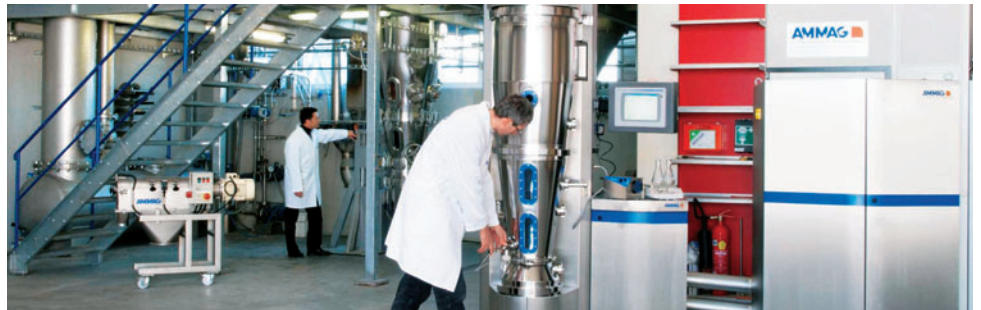
Der neue Labor-Granulator A-WT25 zum Trocknen, Granulieren, Agglomerieren und Coaten ist ideal geeignet für erste Machbarkeitsstudien und zum Austesten neuer Verfahren und Produkte.
