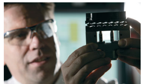
DI Bernd Gombert stellte die neueste Entwicklung von Siemens VDO, die elektronische Keilbremse, vor.
