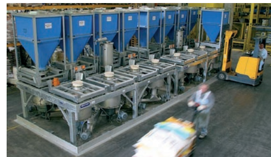
Mit der Dosieranlage der Daxner GmbH können Rohstoffe mit höchster Genauigkeit dosiert und gewogen werden.
