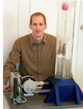
Herbert Grabner demonstriert seine Entwicklung eines Motors: Mit Hilfe einer lagerlosen Pumpe wird ein Wasserstrahl nach oben gespritzt.
