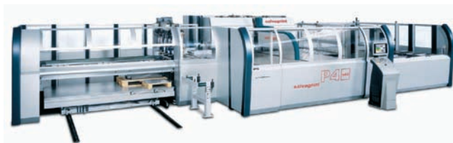
„P4“ Blechabkantmaschine von Salvagnini
