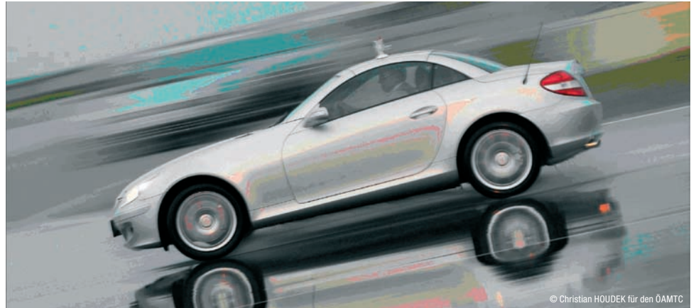
Test der Echtzeit-Positionsbestimmung auf einer Teststrecke. Das Auto benötigt einen am Dach befestigten Transponder. Die Teststrecke ist mit Basisstationen umgeben, in denen die Berechnung der Position erfolgt.
