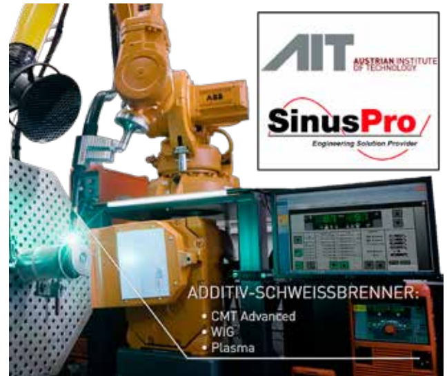
Additiv-Schweißbrenner des AIT: CMT Advanced, WIG, Plasma Bild: SinusPro GmbH
