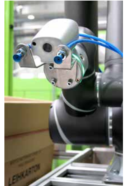
Der Vakuum-Greifer ist eine Sonderanfertigung von TAT für dieses Automatisierungsprojekt. Bild: TAT
