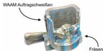
Der Kolben des Motors für das Rennmotorrad wird mittels innovativem WAAM-Verfahren gefertigt. Bild: SinusPro GmbH
