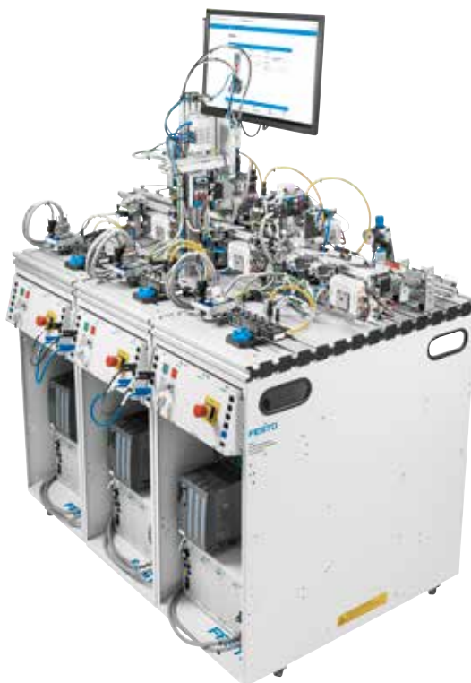
Das neue MPS System 203 I4.0 bietet einen guten Einstieg in IT-Themen und die Vernetzung im Fertigungsumfeld – ganz im Sinne von Industrie 4.0. (Alle Bilder: Festo)
